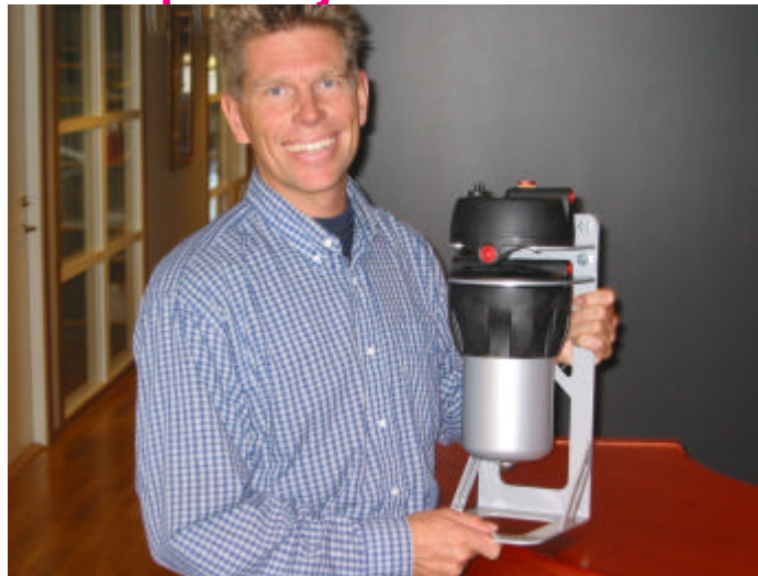
Daniel Andersson visar upp företagets oljeprocessor, förångaren är placerad överst och bomullsspolen i den nedre behållaren.
