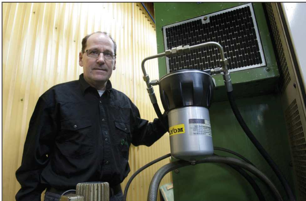
Filter renar oljan. En av fördelarna med by-passfiltren är att de renar oljan medan maskinen är i gång.
