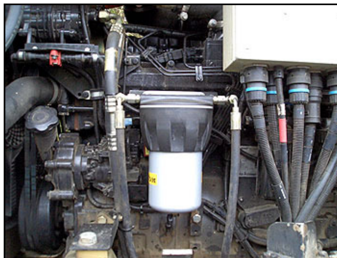
COT-filter på en Valmet 901.3. Foto: Lyom
