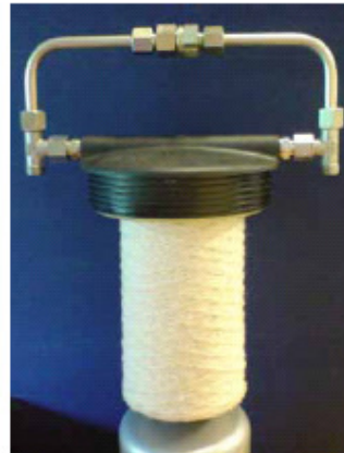
Insatsefiltret av preparerad bomullstråd är mycket effektivt.
