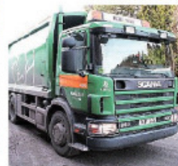
Bilen har gått sedan juli 2006 med samma hydraulolja och resultatet är tydligt. Oljan håller idag bättre kvalitet än den ursprungliga. Inga oljeleraterade hydraulhaverier eller slangbrott har inträffat. Ingen märkbar förtäring på pump eller kolvar.
