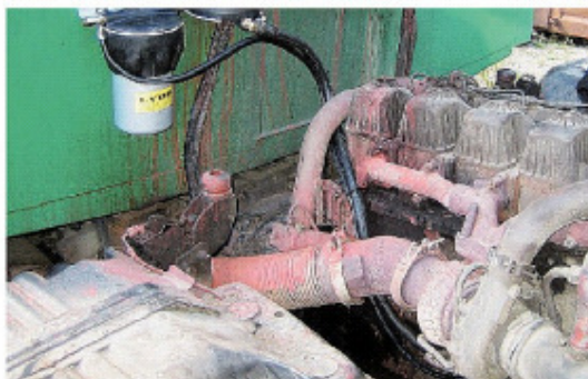
Leif Åhl Verkstad i Lidköping säljer by-passfilter som kontinuerligt renar oljan och som kan monteras på de flesta maskiners motorer och/eller hydraulsystem.
